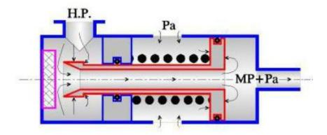
La HP « aide » à la fermeture du clapet sur le siège par les épaulements sur le clapet
