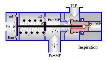
Deux membranes de surface différentes isolent le ressort du milieu extérieur, et l'air entre ces membranes est à la P.A. au montage
